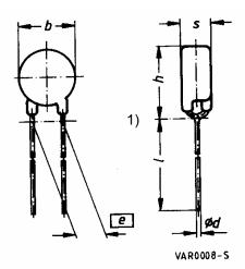
7.0  $b_{\text{max}}$ 10.0  $h_{\text{max}}$ = 3.3 =  $\textbf{S}_{\text{max}}$ 5.0 +0.6/-0.1<sup>2)</sup>  $I_{\min}$ n.a
