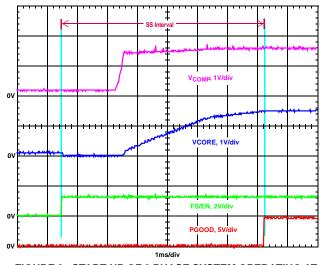
FIGURE 9. START-UP OF 3 PHASE SYSTEM OPERATING AT 300kHz
